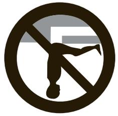
**Piégeage des membres** - Un membre inséré dans une ouverture de sortie d'aspiration ou de couvercle de sortie d'aspiration qui est endommagé, cassé, fissuré, absent ou détaché peut conduire à un accrochage mécanique ou à l'enflure du membre.
