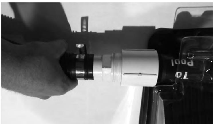
**12.** Connectez le tuyau flexible (fourni) au tube de sortie d'eau "To Pool" (Vers la piscine) et son extrémité au retour d'eau de la piscine. Vissez le collier de serrage avec un tournevis.
