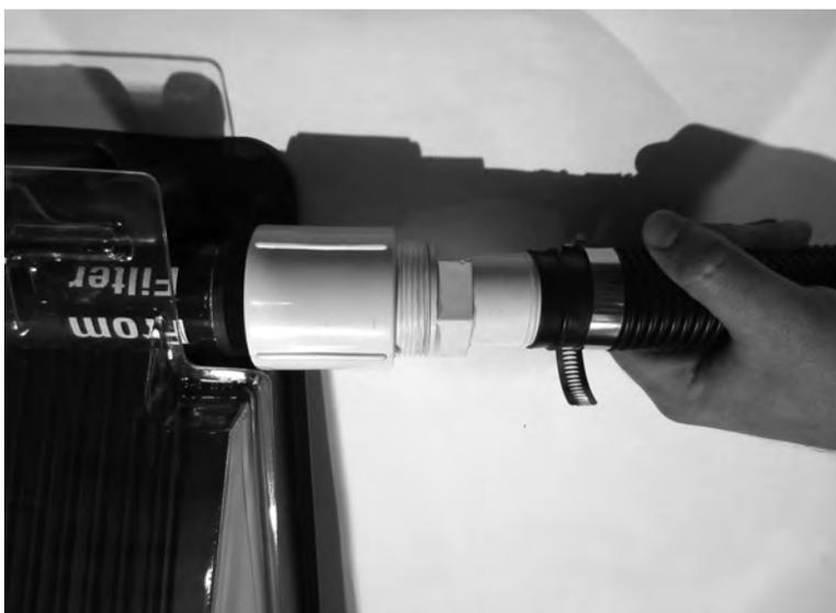
**11.** Prenez le bout du tuyau qui a été enlevé du retour d'eau et connectez-le au coude du tube d'entrée d'eau "From Filter" (Filtre). Vissez le collier de serrage avec un tournevis.
