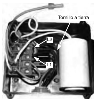
Cableado de 230 VCA (de fábrica)
