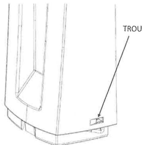
Avant de placer la toile contre la paroi, introduisez le boyau d'un aspirateur dans l'orifice du retour d'eau jusqu'à environ 15 cm (6") du sol.
