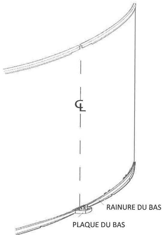
Insérez la paroi dans la rainure inférieure en commençant au centre d'une plaque. Au départ, une ou deux barres de soutien maintiennent la paroi en place. Une personne déroule la paroi sur un madrier ou une planche, tandis qu'une autre personne l'insère dans la rainure inférieure. On ne doit pas dérouler plus de 3 m (10') sans mettre en place une barre de soutien pour renforcer la structure.
