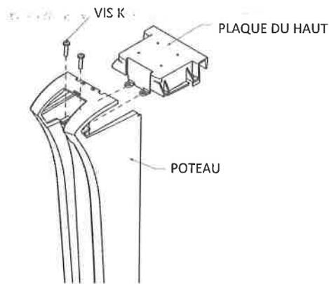
Déposez la plaque du haut sur les montants verticaux. Posez les vis à métal au haut du montant vertical en vous assurant que les montants soient perpendiculaires à la surface du sol.
